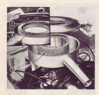
Fig. 14. Air Filter 1. Top Cover
