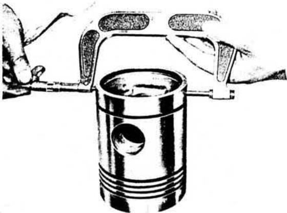
Fig. 22. Measuring a piston.
