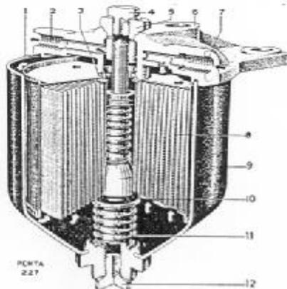
Fig. 26. Fuel filter, C.A.V.
