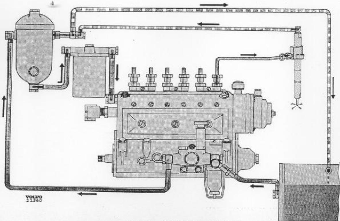
Fig. 23. Fuel system (Bosch).
